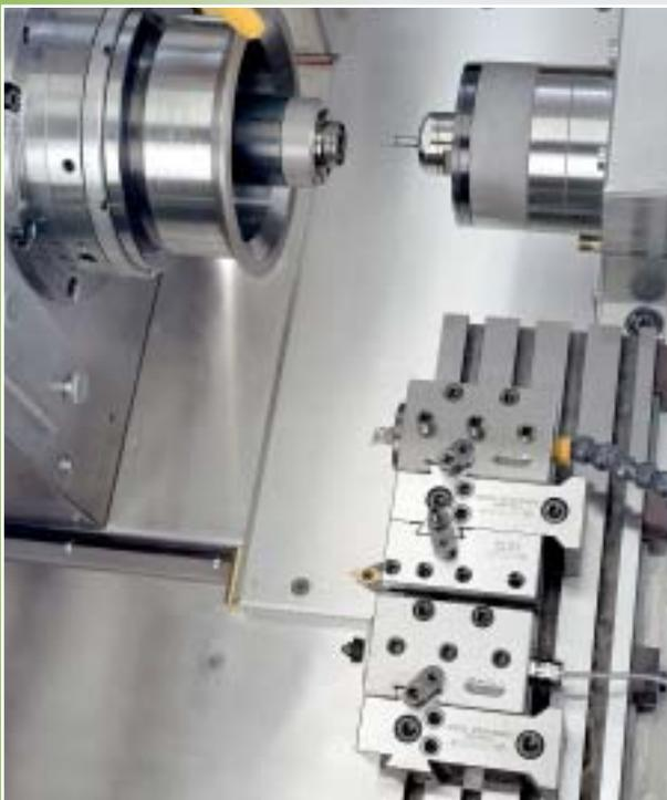
▲ Arbeitsraum mit Schleifspindel mμFuture B1
